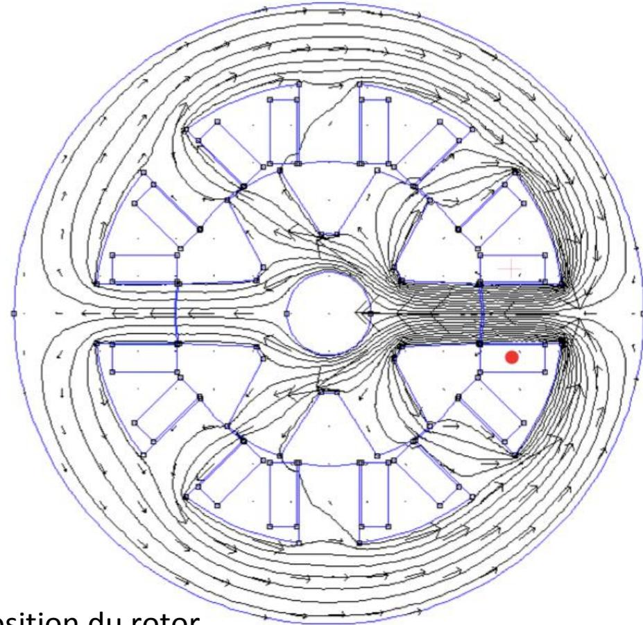
Le flux est fonction du courant et de la position du rotor.
