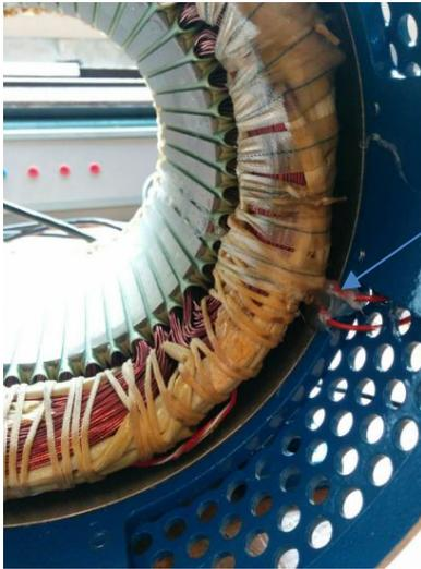
Deux sondes de flux placés à 180 degrés mécaniques
